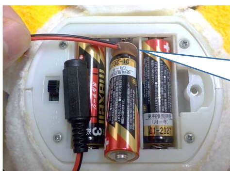
電極と乾電池の間に銅板を挟む
