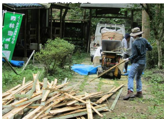
竹を粉碎する機械に入るように竹をハンマ で叩き揃えます。
